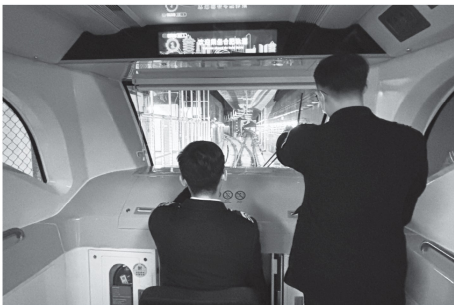
全自動運転の地下鉄。運転席には二名の職員がいますが、彼らは「指差し」をしながら安全チェックを行っているだけで、運転は行っていません（運転装置もありません）。この場所はオープンな空間で、乗客が自由に立ち入って見学ができます。
